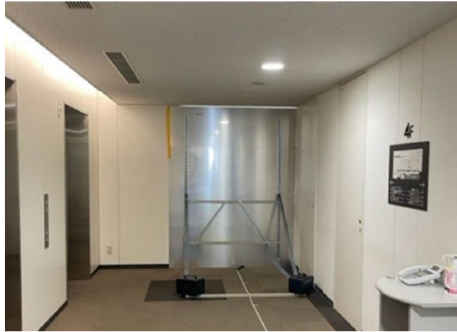
図 2. 2-10 アルミ板による遮蔽による測定環境（案件番号 R4-28）
